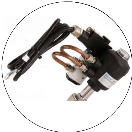
◆ 双作用角座阀采用两位五通式电磁阀控制，附件使用了NAMUR 阀适配安装阀板； 电磁阀型号： 4M210-08/4M310-08
