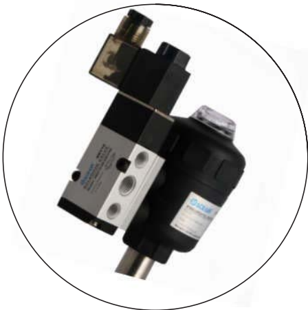
◆ 双作用角座阀采用两位五通式电磁阀控制，附件使用了NAMUR 阀适配安装阀板； 电磁阀型号： 4M210-08/4M310-08
